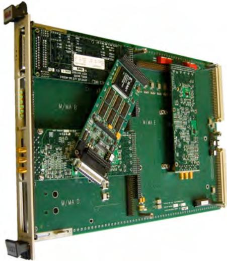
**Figure 2. VXI M-Module Carrier**
