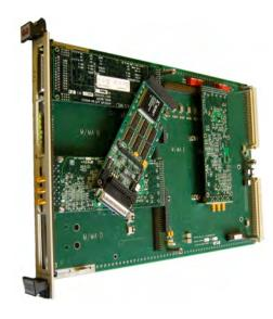
Figure 2. VXI M-Module Carrier
